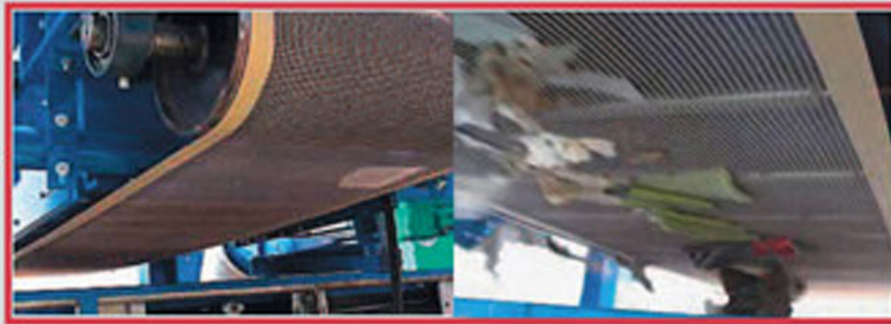
強力な吸引力を持ったネットコンベヤにより搬送コンベヤ上の対象物を吸引
