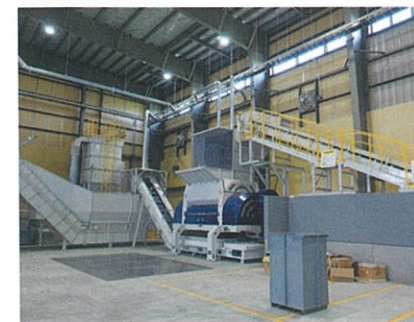
▲1軸破碎機で50mmアンダーに破碎
