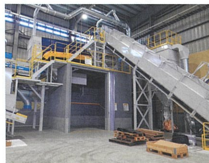
▲2軸破碎機で粗破碎
